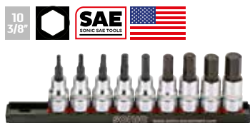
Index IC: 200902 Sada nástrčných klúčov 3/8", šesťhranna na koľajnici, 9ks 3/8", 1/8", 5/32", 3/16", 7/32", 1/4", 5/16", 3/8", 7/16", 1/2"
